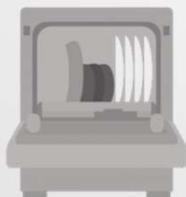
食器洗浄機の導入により、手作業の時と比べ、洗い、すすぎ、拭き上げの3工程をすべて自動で行うことが可能となり、作業時間を1/5程度まで短縮することができ、労働能率の増進を図ることができた。
